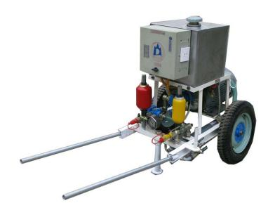
YYTZ26-1 机组:配备一台 YYTZ26 支腿式全液压凿岩机,凿孔直径 32mm-46mm,凿孔速度 0.5-0.8m/min。总重 265 公斤,每小时电耗约 8 度. 该机组可与多种专用钻架配套,用于石材开采和隧道锚杆、灌浆孔施工等.在山西神池、宁武引黄工程中,曾完成过孔径 Φ46,孔 深 4.5 米的灌浆孔近 20 万个.
